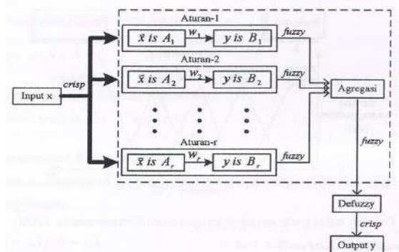
Gambar 11 Diagram blok sistem inferensi fuzzy (Sumber: Jang, dkk., 1997)
