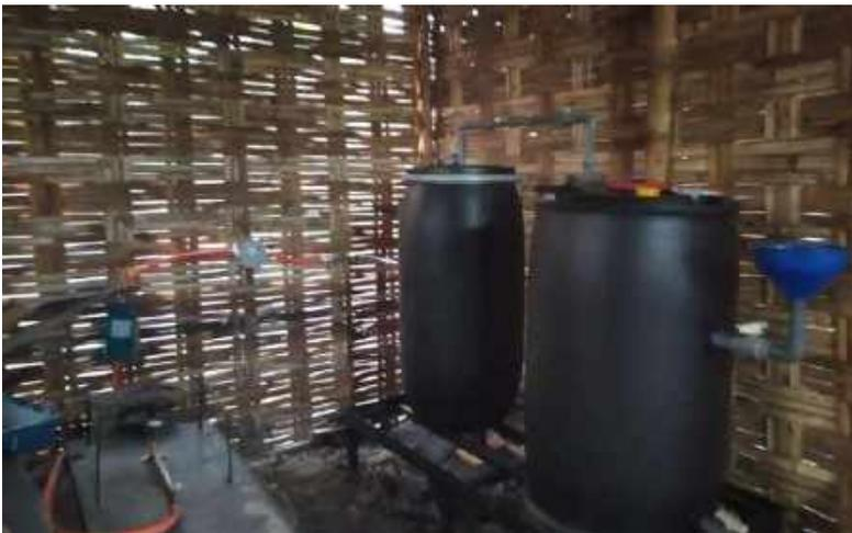
Gambar 5.4. Instalasi Biodigester *Portable* Yang Digunakan Untuk Membuat Biogas Dari Limbah Cair Tahu
