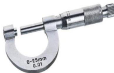
Gambar 1.3. Mikrometer sekrup
