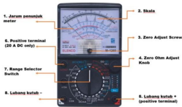
Gambar 1.10. Pengukur Listrik (Avometer)
