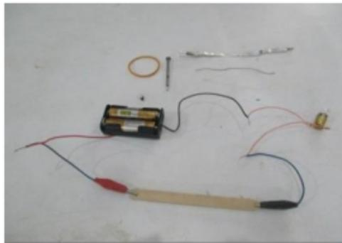
Gambar 4.2 Rangkaian uji coba bahan konduktor dan isolator
