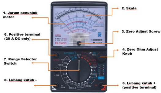
Gambar 1.10. Pengukur Listrik (Avometer)
