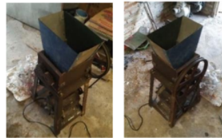
Gambar mesin pencacah sampah plastik
