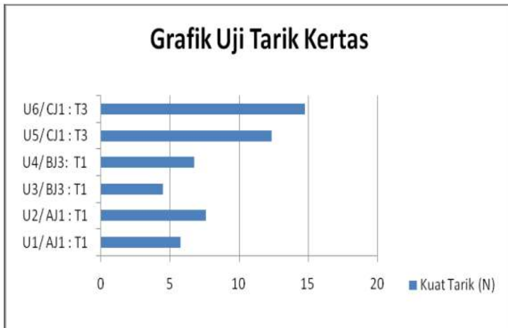
Gambar 4.3 Diagram uji tarik kertas dari limbah kulit jagung dan ampas tebu
