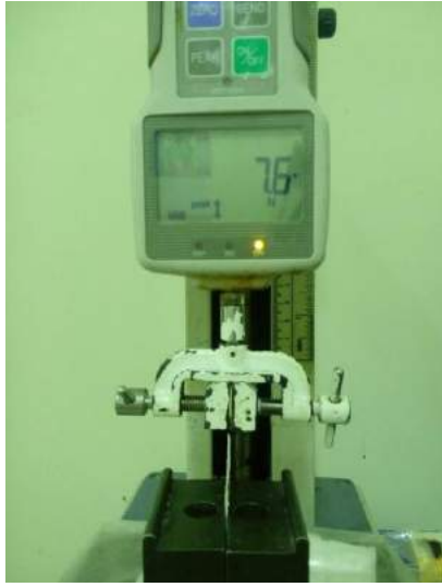
Gambar 4.2. Proses pengujian tensile strength dan elongation
