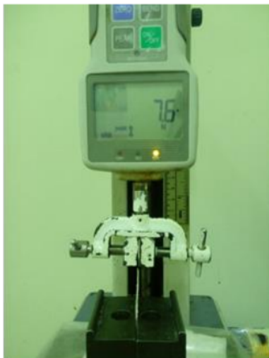
Gambar 4. Proses pengujian tensile strength dan elongation
