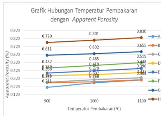
Gambar 4. Grafik Hubungan Temperatur Pembakaran dengan Apparent Porosity.
