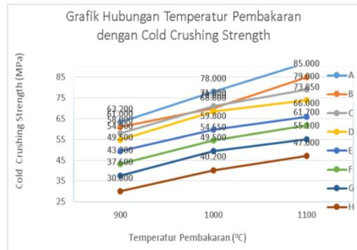
Gambar 3. Grafik Hubungan Temperatur Pembakaran dengan Crushing Strength
