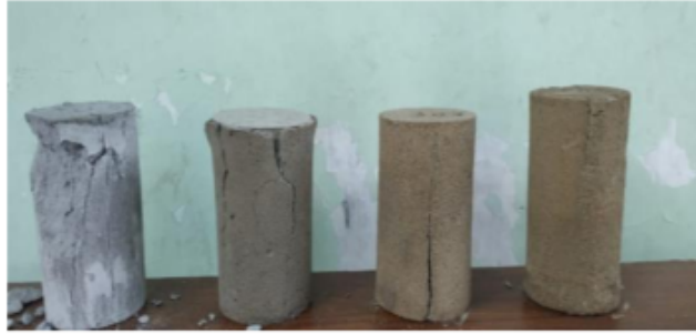
Gambar 5.8 Batako ringan yang telah diuji kuat tekan
