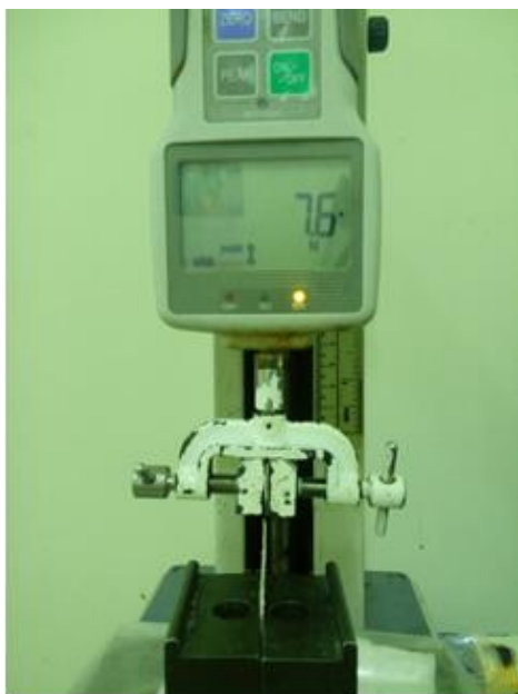
Gambar 4. Proses pengujian tensile strength dan elongation
