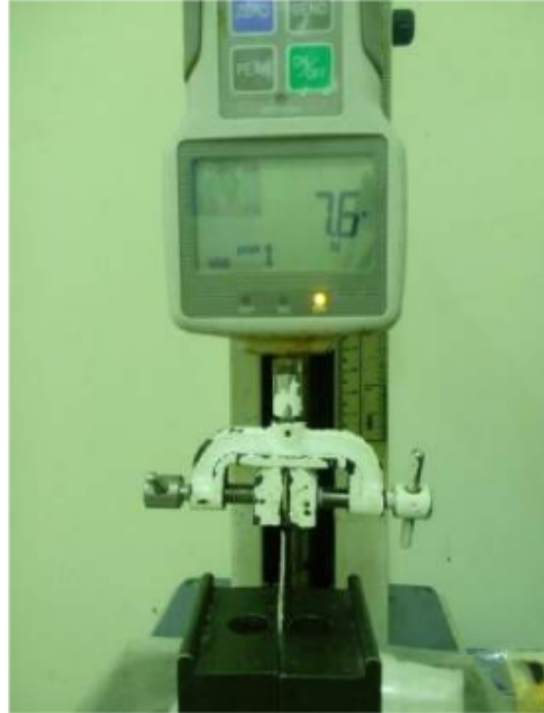
Gambar 4.2. Proses pengujian tensile strength dan elongation
