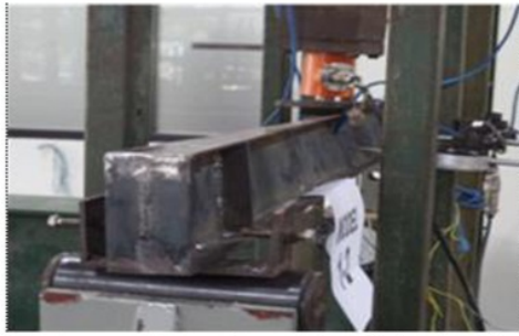
Gambar 11. Keruntuhan total pada benda uji
