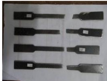
Gambar 8. Bentuk putus uji tarik pelat baja
