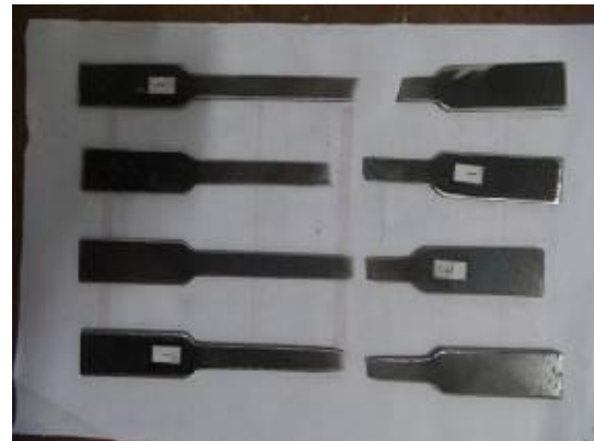
Gambar 9. Bentuk putus uji tarik pelat baja
