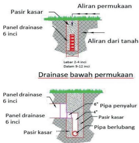
Gambar 1.3 Ilustrasi drainase bawah permukaan (Hidayat, Sutanto and Putra, 2016)
