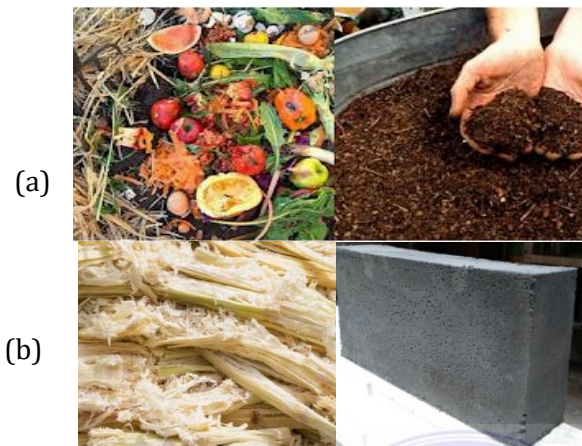
Gambar 2.1 (a) Pengolahan limbah organik menjadi pupuk kompos (b) ampas tebu menjadi batako ringan
