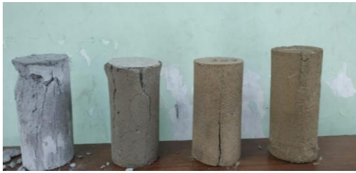
Gambar 5.8 Batako ringan yang telah diuji kuat tekan
