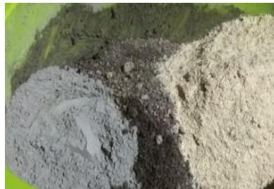
Gambar 5.1 Bahan baku pembuatan komposit batako ringan (Pasir, semen, dan serbuk kulit jagung)
